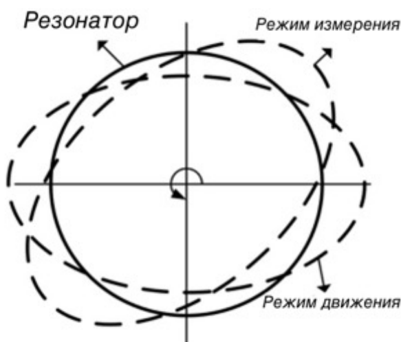
Рисунок 6 – Колебания полусферического или кольцевого резонатора
